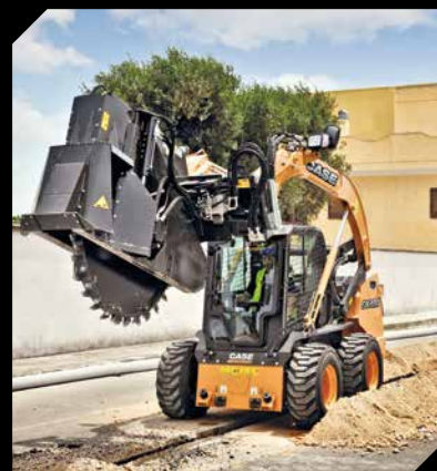
Der CASE Kompaktlader ist dank unterschiedlichster Anbauwerkzeuge vielseitig einsetzbar.
